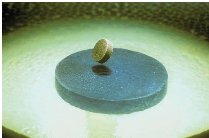
Fig. 2.35. Efecto Meissner. Una de las propiedades de los superconductores es que sobre ellos levitan los imanes.
