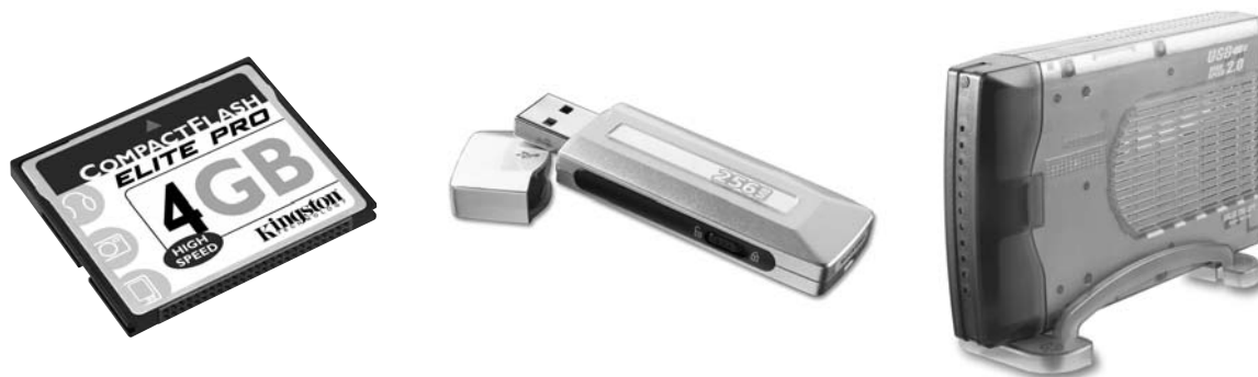
Figura 1.9. Tarjeta compact flash (izquierda), memoria flash USB (centro) y disco duro (derecha).
