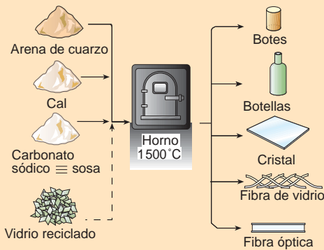
Fig. 11.45. Proceso de obtención del vidrio.
